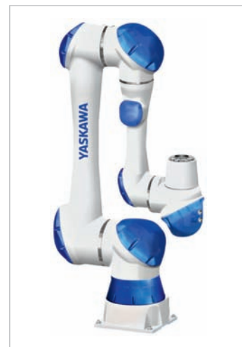
Robot MOTOMAN HC10 možno teraz naprogramovať pomocou funkcie Smart Pendant alebo Direct Teaching
