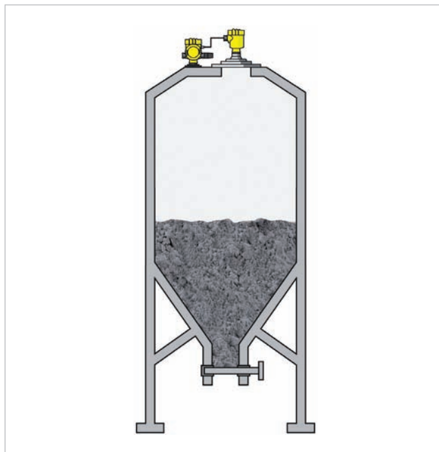
Obr. 4 Měření zaplnění mobilního sila: údaje z radarového hladinoměru Vegapuls 69 jsou přenášeny prostřednictvím jednotky Plicsmobile T81
